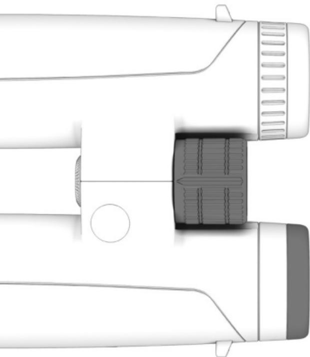
Därefter sluter du höger öga och tittar med vänster öga genom kikaren på ett objekt. Fokusera nu detta objekt skarpt.
