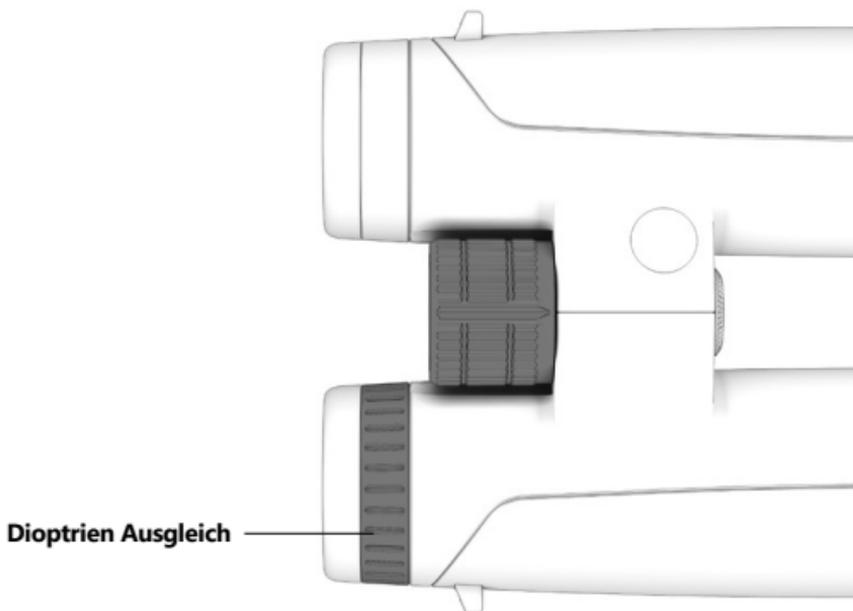
Im Anschluss schließen Sie das linke Auge und blicken mit dem rechten Auge durch das Fernglas auf ein Objekt. Stellen Sie dieses Objekt nun mit dem Dioptrienausgleich scharf.
